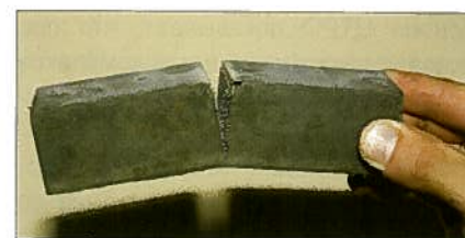
Рис. 4. Характер разрушения тампонажного камня с армирующим волокном при определении предела прочности на изгиб
